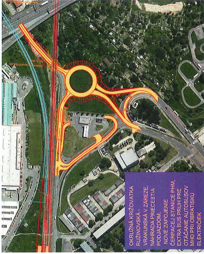
13) Obr. – riešenie mimourovňového križenia trate s Vrakunskou cestou a križovatky Vrakunská – Ružinovská ako okružnej
