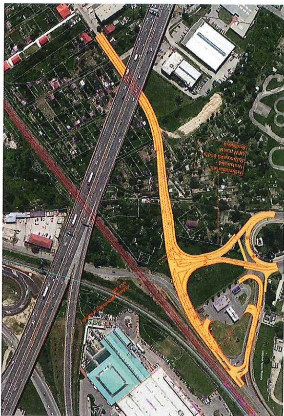
15) Obr. - riešenie preložky Vrakunskej cesty podľa územného plánu mesta a križovatky Vrakunská – Ružinovská ako stykovej, zrušenie priecestia bez náhrady
